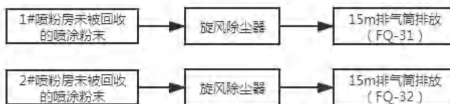
图 7.1-7 喷涂粉尘治理设施工艺流程图
