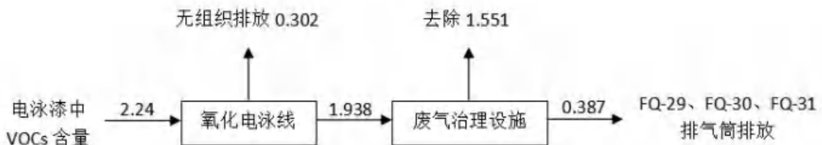
图 4.5-4 电泳线总 VOCs 物料平衡图
